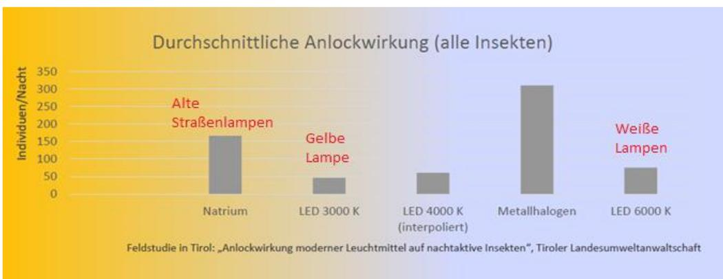
Nachteilig ist, dass die Effizienz der „gelben“ Lampen nicht so groß ist wie bei den „weißen“ Lampen. D.h. man braucht mehr Strom für die gleiche Ausleuchtung oder man muss eine geringere Ausleuchtung bei gleichem Stromverbrauch akzeptieren. Allerdings liegt die Effizienz immer noch deutlich über dem Wert der herkömmlichen alten Natrium-Glühlampen.
